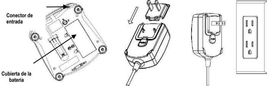
**Instalación de la batería** (sin la batería interna opcional):
